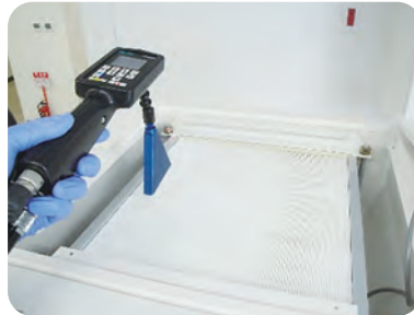
HEPAフィルタ性能試験(透過率試験)
