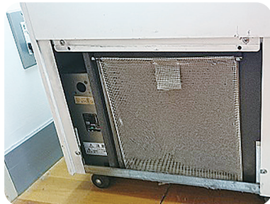
人工気象器の汚れ(凝縮器フィルタ)
