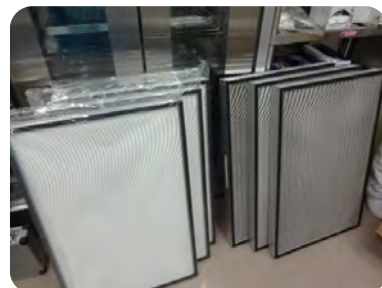
消耗品交換(HEPAフィルター)
