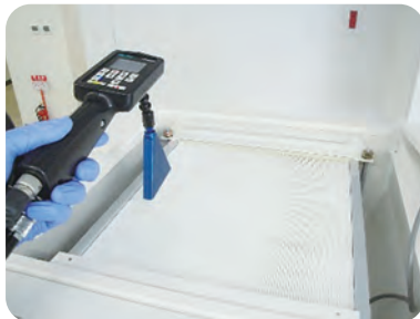
HEPAフィルタ性能試験(透過率試験)
