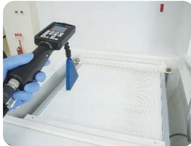
HEPAフィルタ性能試験(透過率試験)
