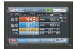
プログラム制御のLPH型 プログラムは24ステップ/5パターン、 パターンリンク機能付き
