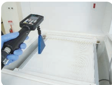
HEPAフィルタ性能試験(透過率試験)
