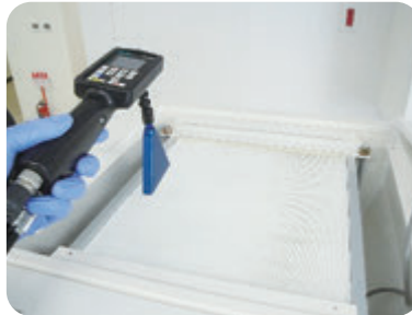
HEPAフィルタ性能試験(透過率試験)
