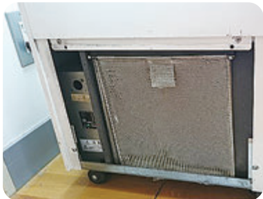
人工気象器の汚れ(凝縮器フィルタ)
