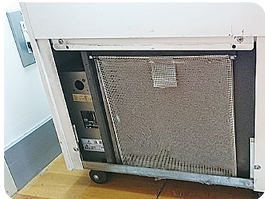
人工気象器の汚れ(凝縮器フィルタ)
