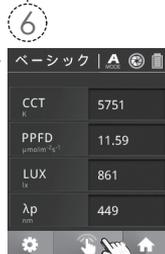
画面の測定ボタン/本体の測定キーを押すと、連続測定を開始します。
