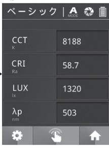
“ピー”という音が鳴れば、\*測定完了です。測定結果が画面に表示されます。
