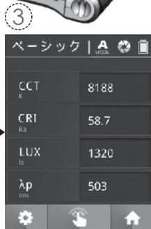
“ピー”という音が鳴れば、測定完了です。測定結果が画面に表示されます。
