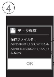
測定データがSDカードに保存されます。測定されたデータを探る場合は、測定された際の日時、時間をご参照下さい。
