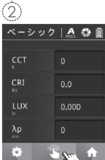
画面下の中央の測定ボタンをタップして下さい。又は本体横の測定キーを押しても測定可能です。(タッチ測定と測定キー測定の両方で測定ができます。)
